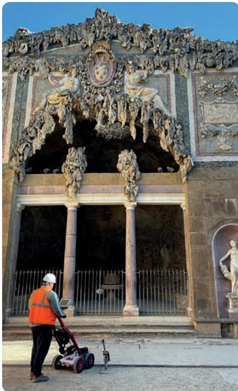
Il georadar, noto anche come GPR (Ground Probing Radar) è una metodologia non invasiva utilizzata in geofisica nello studio del primo sottosuolo, che si basa sull'analisi delle riflessioni di onde elettromagnetiche trasmesse nel terreno.
